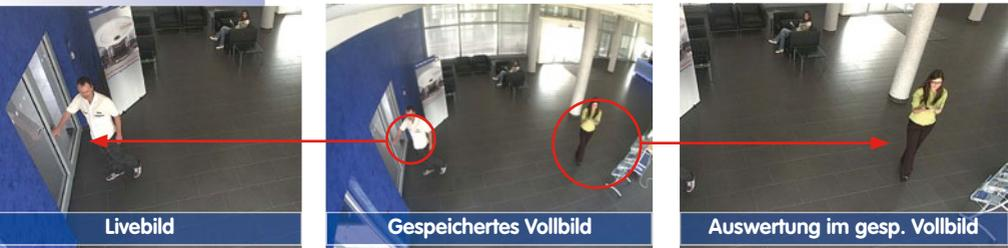
Hier können nun live z. B. in VGA-Auflösung vPTZ-Aktionen durchgeführt werden, während durch die Vollbildspeicherung z. B. mit 1 B/s ein Bild im Format MEGA oder QXGA abgespeichert wird.
