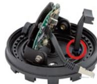
8. Schrauben Sie nun das Kamerainnere durch Drehen des gezahnten Rings (im Uhrzeigersinn) so weit fest, dass Sie das Kamerainnere noch ohne große Krafteinwirkung drehen können.
