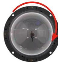
9. **Gummi-Abschlussring montieren (nur IT/Secure-Modelle):** Den Gummi-Abschlussring mit der Nut um den Rand des schwarzen Montagerings legen.
