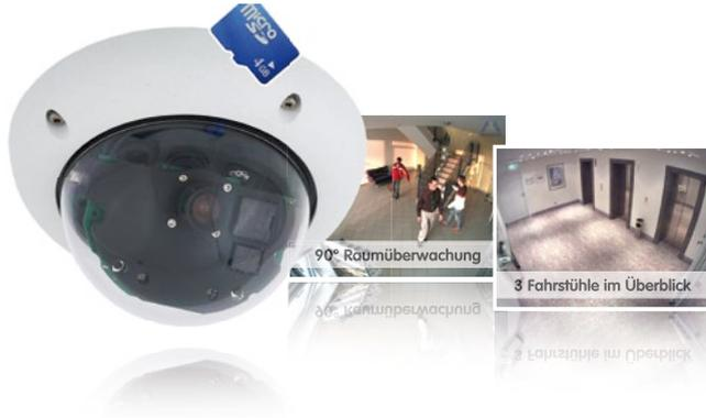
Mit der D24M-Familie bietet MOBOTIX äußerst kompakte, vielseitige und kostengünstige MonoDome-Kameras mit bis zu 1.536 Bildzeilen, integriertem Videosensor und kamera-interner Langzeitspeicherung auf MicroSD-Karte (nicht in der Basic-Variante verfügbar). Das Grundmodell D24M-Basic ist für den Einsatz im Innenbereich ausgelegt, beinhaltet bereits ein 90° Weitwinkelobjektiv und wird über Power-over-Ethernet (PoE) versorgt.
