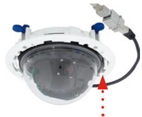
6. **Kabel anschließen:** Das zugeführte Netzkabel über einen (handelsüblichen) Verbinder mit dem Netzkabel der Kamera verbinden.
