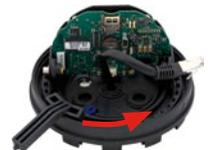
4. **Trennen Sie das Kamerainnere** mit dem Objektivträger vom Gehäuseboden.
