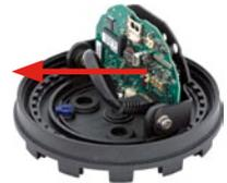
3. **Lösen Sie das Kamerainnere**, indem Sie zunächst die beiden blauen Klemmnocken mit der schmalen Seite des Hakenschlüssels lösen.
