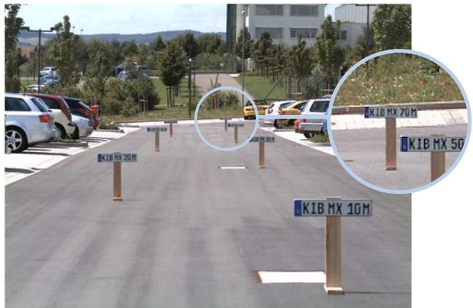
Ein L135-Teleobjektiv ermöglicht einer D24M mit hochauflösendem 3,1 Megapixel-Sensor, beispielsweise aus rund 75 Metern Entfernung noch ein KFZ-Kennzeichen lesbar aufzuzeichnen. Oder aus rund zwei Metern Entfernung die Seriennummer eines Geldscheins!
