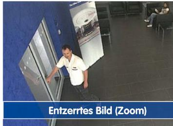
Gerade bei Anwendungen mit niedriger Bildrate und nicht gezoomten Bildern (z. B. beim Einsatz der D24M als Webcam) empfiehlt es sich, die Objektivverzerrung zu aktivieren. Grundsätzlich kann diese Korrektur aber auch erst nachträglich bei der Recherche auf die aufgezeichneten Bilder angewendet werden. Dies spart Rechenleistung während der Aufzeichnung und erhöht die Bildrate. Je stärker in das Bild hineingezoomt wird, desto geringer ist grundsätzlich der Verzerrungseffekt.
