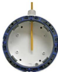
5. **Kamera-Gehäusering entfernen:** Alle vier Inbusschrauben mit dem mitgelieferten Inbusschlüssel abschrauben. Gehäusering abnehmen (ab Werk ist der Gehäusering nicht montiert).
