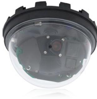
1. Schrauben Sie die **transparente Domekuppel** der Kamera **gegen den Uhrzeigersinn** ab. Um ein Verunreinigen der Kuppel zu verhindern, verwenden Sie hierbei die mitgelieferte Folie oder ein fusselfreies Baumwolltuch.
