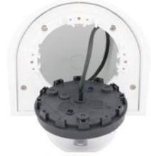
4. **Kamera auf der Abdeckplatte einrasten:** Kamera fest auf den Wandhalter drücken. Die Kunststoff-Federbügel rasten ein, wenn die trapezförmigen Elemente auf der Rückseite des Kameragehäuses exakt in den hierfür vorgesehenen Öffnungen des Wandhalters eingepasst werden.
