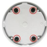
2. **Kabelzuführung vorbereiten:** Dichtelement in verwe-dete Kabelaufnahme des Aufputz-Sets stecken, schwarzer Dichtgummi liegt außen. Von innen mit schmaler Sechskantmutter fixieren.
