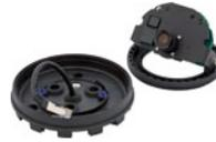
5. **Positionieren Sie den Gehäuseboden über den Bohrlöchern** und dem vorbereiteten Kabelaustritt. Bitte beachten Sie, dass der Kamerasockel relativ eng mit dem Untergrund abschließt und das Netzkabel inkl. Verbinders daher in der Decke oder Wand versenkt sein sollte. Da die drei Durchlassöffnungen für die Schrauben im Gehäuse ring ab Werk verschlossen sind, müssen diese z. B. mit einem 5 mm-Bohrer durchbrochen werden.
