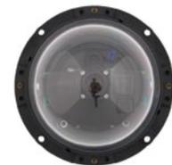
10. **Gehäusering montieren (nur IT/Secure-Modelle):** Gehäuse ring aufsetzen und alle vier Inbusschrauben mit dem mitgelieferten Inbusschlüssel festziehen. Dabei auf den korrekten Sitz des Gummi-Abschlussrings achten.
